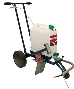
Der Wagen wird mit einem 20-Liter-Wassertank geliefert und hat ein Lineal zum leichten Einstellen der Schnitttiefe. Inklusive Wasser-Kit
